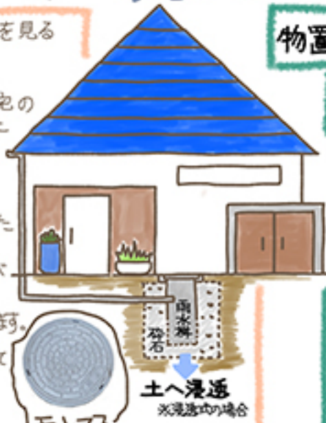
雨水枳 土へ浸透 ※浸透式の場合
